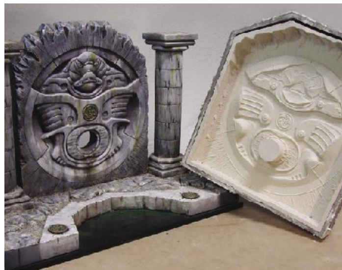
Stampo per modellismo realizzato da DZ MODELS con RTV 3318.
